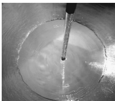
รูปที่ 1.4: ไฮดรอลิกจัมพ์พ่วงกลมเนื่องจากลำน้ำกระทบพื้น
