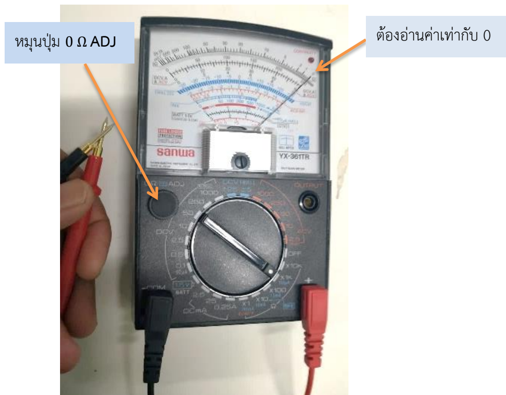
รูปที่ 3 การตั้งค่า 0 ของมัลติมิเตอร์สำหรับวัดความต้านทาน
