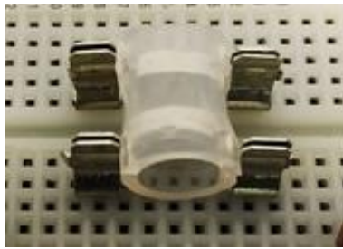
รูปที่ 9 แสดงการยึดหลอด LED ในตัวอย่าง
